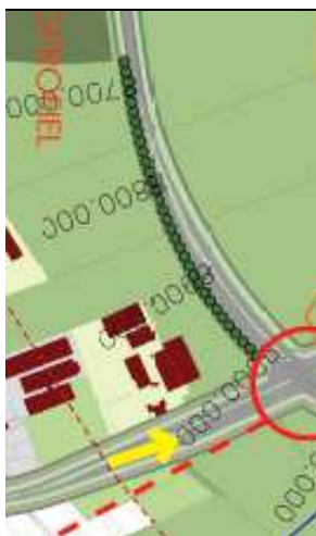
Figuur 3.3 voorbeeld van een inpassingsmaatregel voor alternatief Bo (groenstrook weergegeven met een groene cirkels) westelijke van de nieuwe weg tussen de N937, ter hoogte van Braambosch. Voor de andere optimalisatiealternatieven gelden in dit deel van het zoekgebied vergelijkbare inpassingsmaatregelen met groenstroken.
